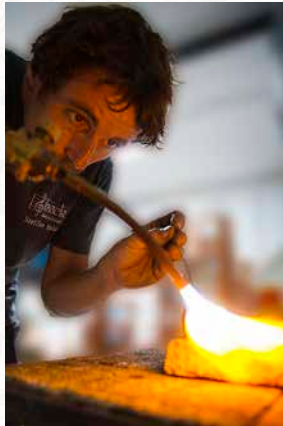
Steffen Holder beim Schlaglöten eines Schallstücks.
